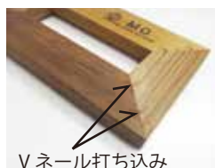
V ネール打ち込み V ネール組
